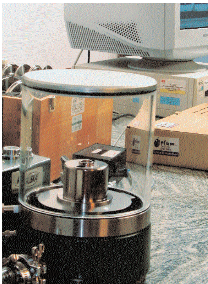
Kalibrator obciążnikowo-tłokowy RUSKA. Laboratorium Plum.
