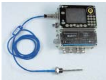
Przelicznik MacBAT II z czujnikiem ciśnienia i temperatury.
