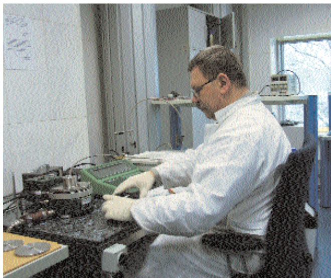
Stanowisko do wzorcowania przetworników ciśnienia, wyposażone w manometr obciążnikowo-tłokowy, jeden z nielicznych w kraju.
