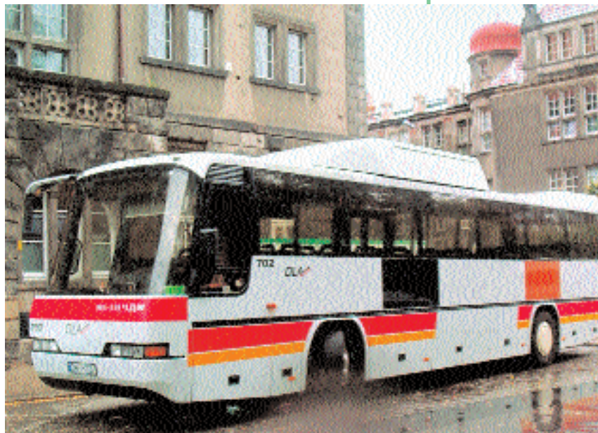
Gazowy autobus Dolnośląskich Linii Autobusowych, z kompozytowymi butlami na dachu pojazdu.
