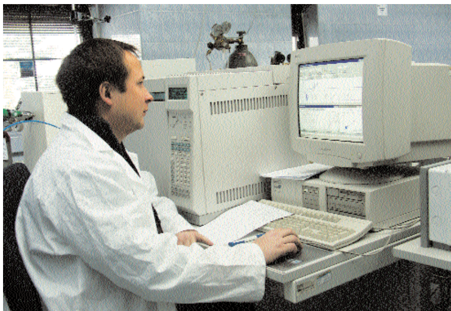
Układ chromatograficzny zarówno procesowy, jak i w stacjonarnym laboratorium, musi stale operować włącznie ze wzorcem gazowym.
