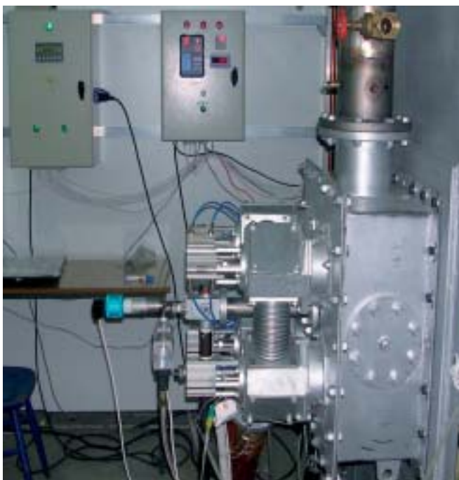
Widok palnika regeneracyjnego HRS mocy 250 kW z automatyką sterującą.
