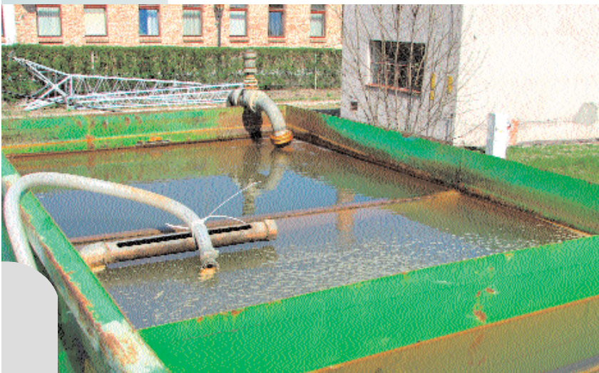
Sopot, ul. Bitwy pod Płowcami 25 – rekultywacja z zastosowaniem Technologii Intensywnej Bioremediacji.
