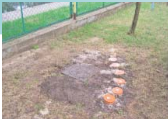
Bydgoszcz, ul. Jagiellońska 42 – piezometry przy rzece Brdzie.
