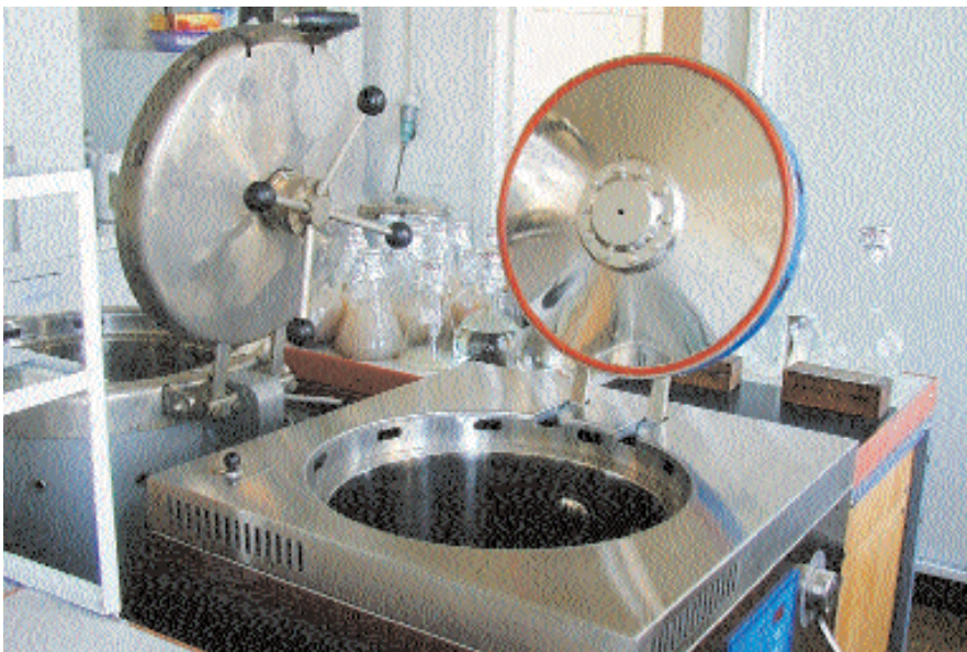
Fot. 2. Autoklawy przeznaczone do sterylizacji podłoży mikrobiologicznych
