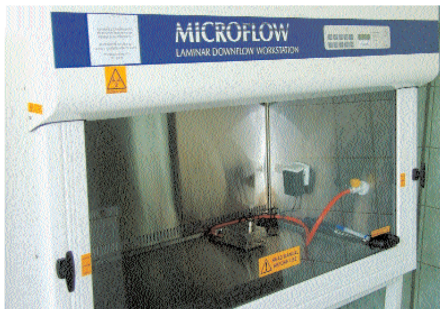
Fot. 1. Badania mikrobiologiczne przeprowadzono z użyciem nowoczesnej aparatury – komory z laminarnym pionowym przepływem sterylnego powietrza firmy MICROFLOW
