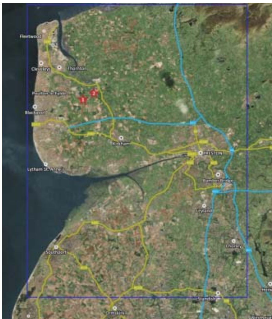
Łupkowe eldorado w pobliżu Blackpool. Wewnątrz niebieskiej linii, wyznaczającej granice koncesji spółki Cuadrilla Resources, w formacji Bowland Shale o grubości dochodzącej do 1000 m, znajduje się podobno 5,66 Tm 3 gazu łupkowego. 1. Odwiert Preese Hall, 2. Odwiert Grange Hill Farm. Źródło: Cuadrilla Resources.
