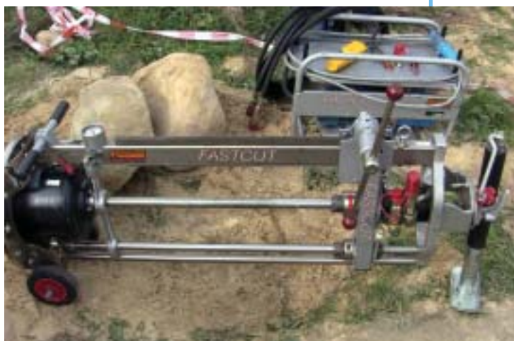
Urządzenie do nawierceń.
