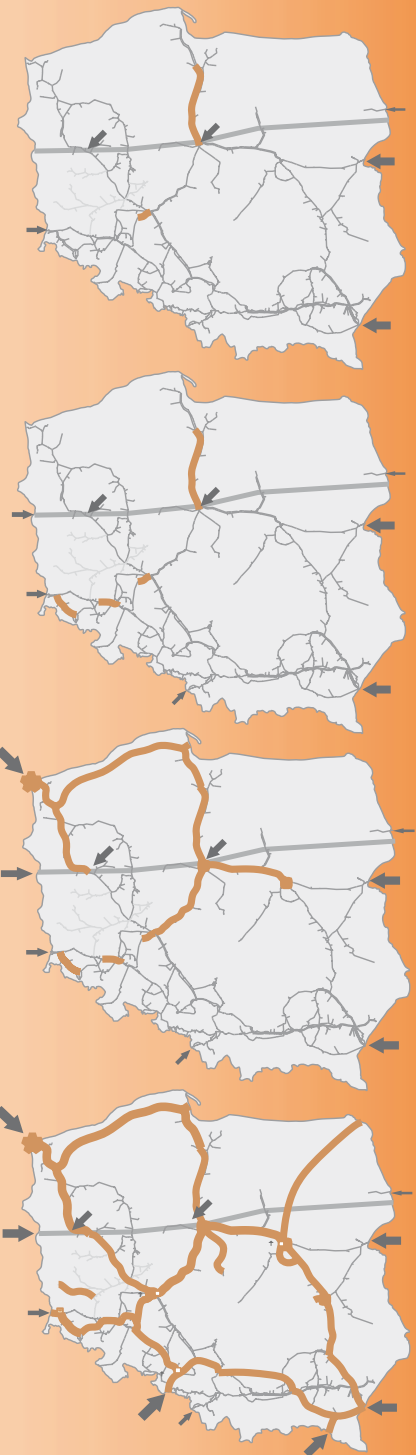
Zasięg sieci przesyłowej 8,4 MPa
