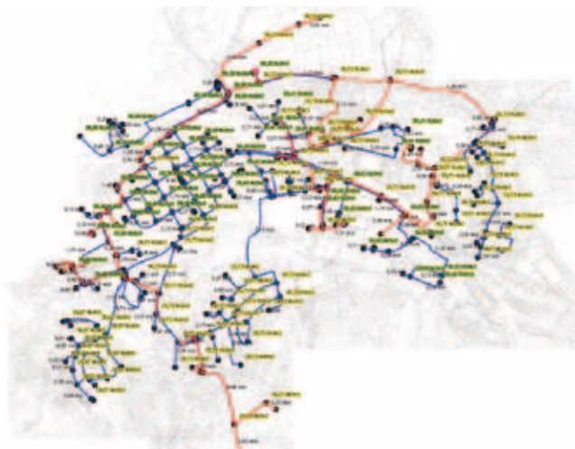
Rys. 8. Rozkład ciepła spalania mieszaniny gaz ziemny/wodór w wariancie drugim (90%/10%).
