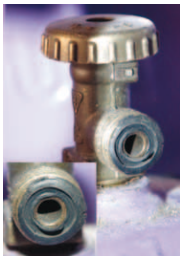
Fot. 2. Uszkodzona uszczelka gniazda zaworu (fot. T. Minor)
