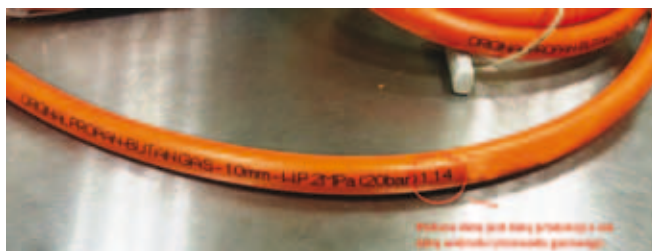
Fot. 1. Oznaczenie przewodu gazowego (fot. T. Minor)
