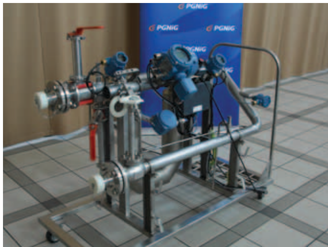
SMOK – mobilne stanowisko do legalizacji liczników na cysternach przewożących skroplony gaz ziemny (LNG).
