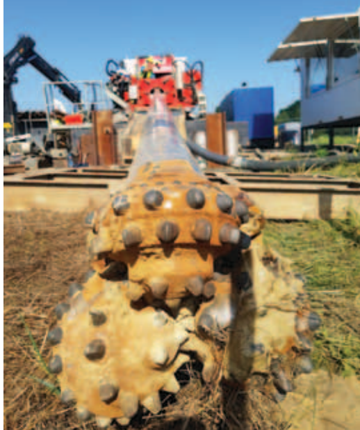
Świder wraz z wiertnicą do wiercenia pilota w technologii Horyzontalnego Przewiercenia Sterowanego.
