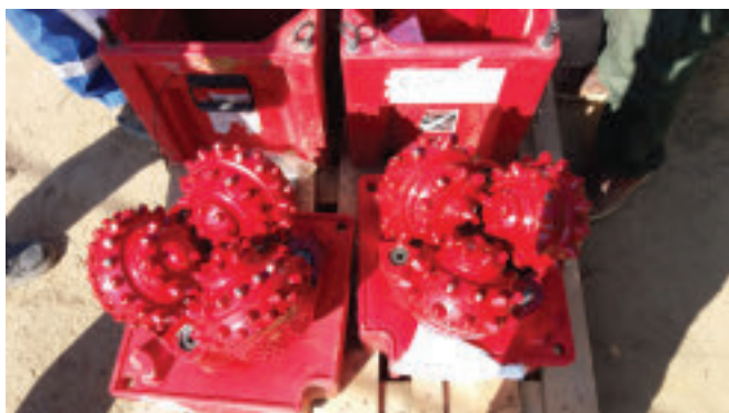
Świdry trójgryzowe z rolkami do zwiercania skał twardych, użyte na HDD pod rzeką San do odwiercenia pilota.
