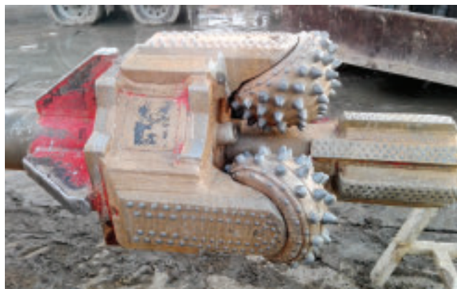
Hole Opener 28 cali, narzędzie do rozwiercania w skałach twardych, użyte na HDD pod rzeką San.
