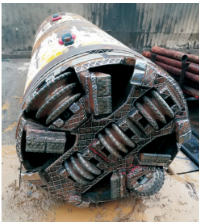
Głowica mikrotunelowa z tarczą wyposażoną w krążki TCI po odwierceniu DP1 na gazociągu Strachocina-Pogórska Wola, widać zużycie powierzchni krążków zbrojonych węglnikami spiekanymi.
