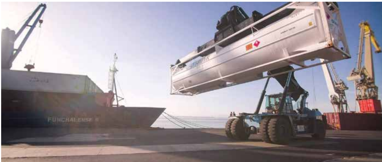
Rysunek 5. Załadunek kontenera 40 ft z LNG na statek przy użyciu reachstackera; Gaslink
