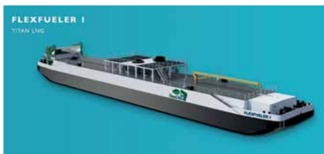
Rysunek 4. Projekt pontonu śródlądowego FlexFueler o pojemności około 1480 m 3 na cele usług bunkrowania w porcie w Amsterdamie
