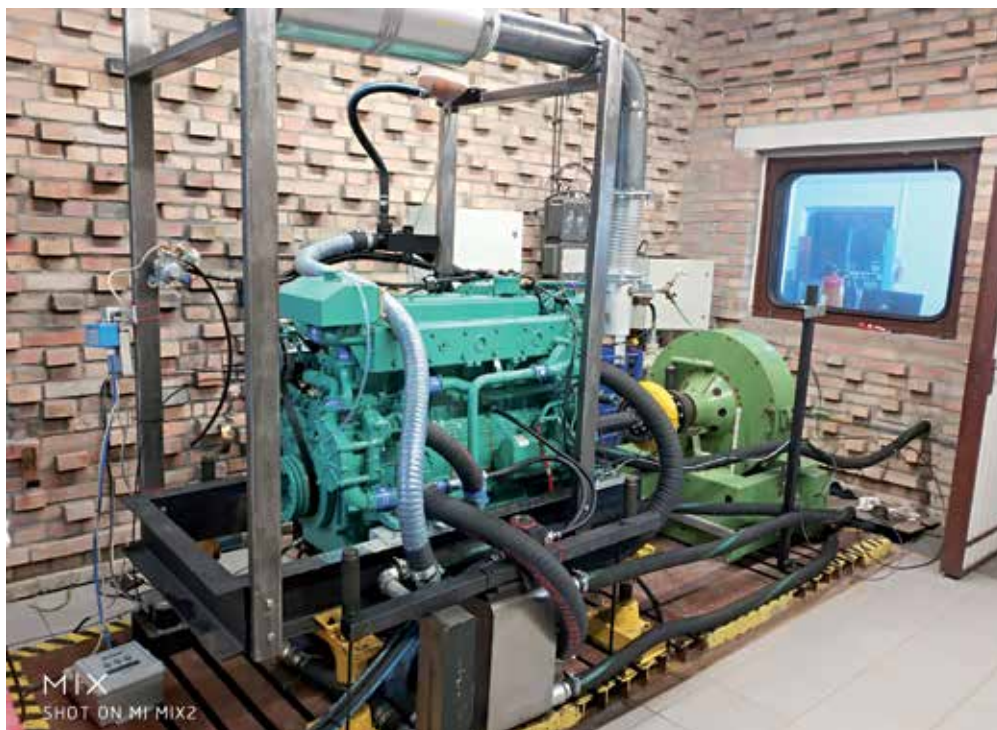
Rysunek 2. Silnik marki DOOSAN, zasilany LNG na stanowisku badawczym Katedry Inżynierii Pojazdów Politechniki Wrocławskiej
