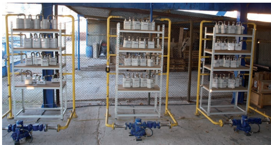
Widok instalacji badawczej do badania trwałości gazomierzy z użyciem mieszaniny gazu ziemnego z wodorem.
