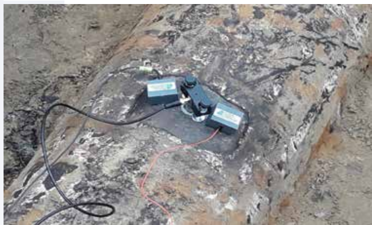
Rysunek 2. Lokalizacja defektu gazociągu z wykorzystaniem emisji AE (źródło własne)
