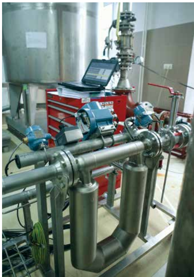
Rysunek 2. Badania metrologiczne instalacji SMOK-1 w Laboratorium Przepływów Głównego Urzędu Miar w Warszawie (marzec 2017).
