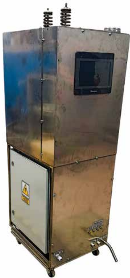
Rysunek 5. Prototyp układu mikrokogeneracyjnego zasilanego wodorem, o mocy 1 kW.
