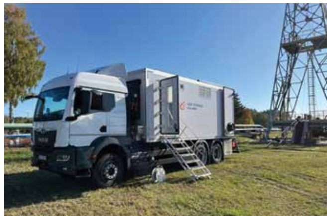
Fot. 1. Specjalistyczny pojazd do pomiarów geofizycznych w kawernach magazynowych i otworach wiertniczych.
