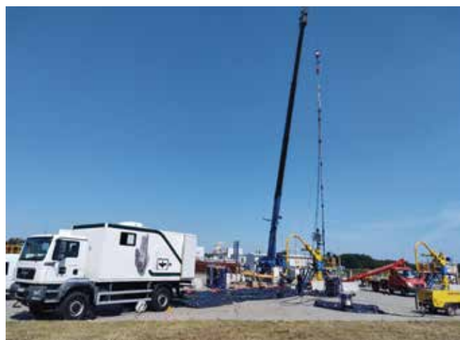
Fot. 4. Śluza ciśnieniowa do wykonywania pomiarów geofizycznych w kawernach magazynowych wypełnionych produktami gazowymi i płynnymi pod ciśnieniem.
