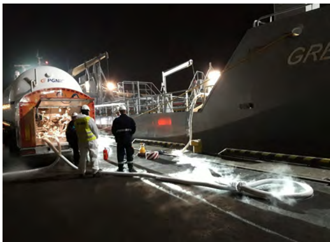
Operacja bunkrowania LNG w technologii TTS (Truck-To-Ship), wykonywana przez PGNiG Obrót Detaliczny.
