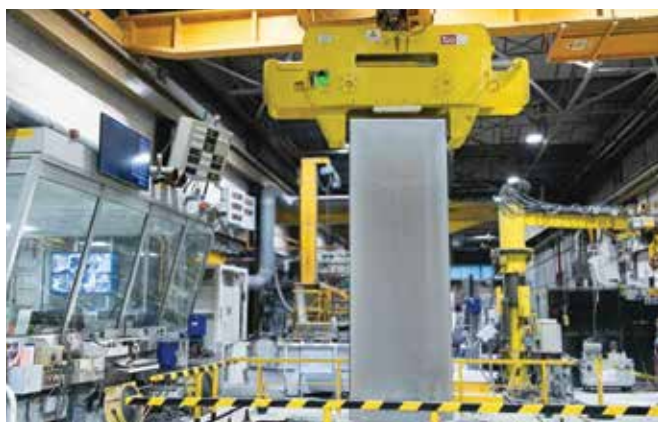
Constellium company, udany wytop 12-tonowej płyty aluminium z użyciem pieca zasilanego wodorem.
