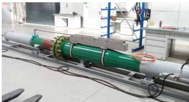
Rysunek 5. Stanowisko badawcze GAZ-SYSTEM, na którym wykonane zostały testy czujników do pomiarów stopnia wydłużenia kompensatorów
